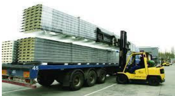
ukážka vykladania panelov vysokozdvížným vozíkom)
