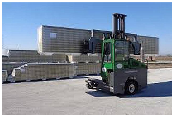
(ukážka vykladania panelov bočným vysokozdvížnym vozíkom)
