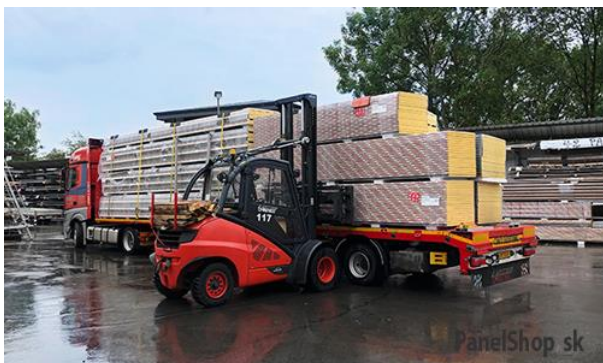
(ukážka nakladania a transportu panelov)
